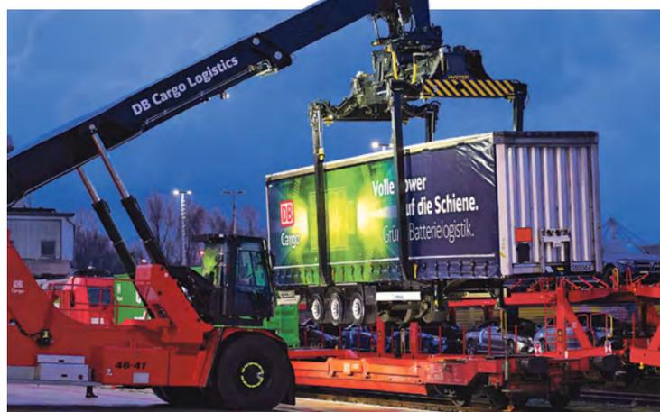
Ein Greifkran entlädt den Lkw-Auflieger mit Batterien an der Bahnumschlaganlage vom Zug. Von hier werden die Energiespeicher in die Batteriehalle gebracht.
