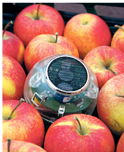
Ein Sensor misst Sauerstoff und Kohlendioxid, um die Atmungsaktivität der Früchte zu bestimmen.
