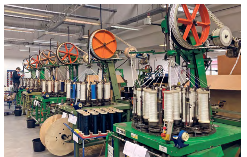
Gleistein setzt auf eigens entworfene Maschinen zur Seilherstellung. Denn es braucht alles andere als Massenware, um Hightech-Seile zu erschaffen.
